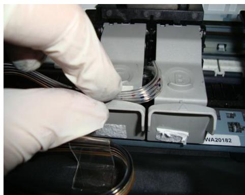
Просуньте шлейф через крышку цветного картриджа. На выключенном принтере подвигайте каретку, вправо и влево. В крайних положениях, шлейф должен иметь незначительную свободу, он не должен чрезмерно болтаться, или слишком натягиваться.
