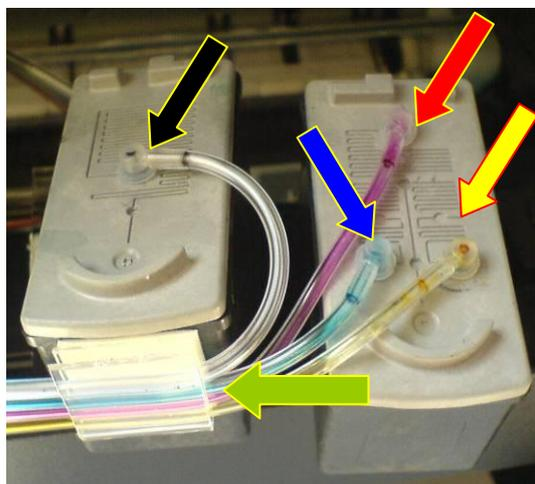
Возьмите картриджи снимите с них наклейки и сделайте в них отверстия сверлом из набора, согласно схемы (показано стрелками).
