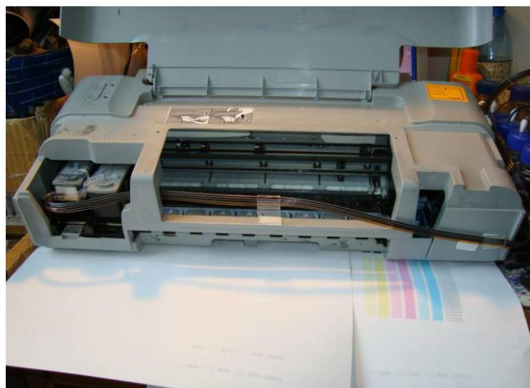
Установите внутри устройства зажимы для шлейфа – клипсы, предварительно протерев места установки спиртом. Проденьте шлейф в клипсы (намочите шлейф в местах крепления водой, так его
