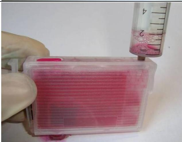
6. Вставьте шприц в воздушное отверстие и вытяните из картриджа 1,5 мл воздуха, в правой воздушной камере может произойти пенообразование. После этого вытащите шприц, вы услышите, как в картридж втянется воздух.
