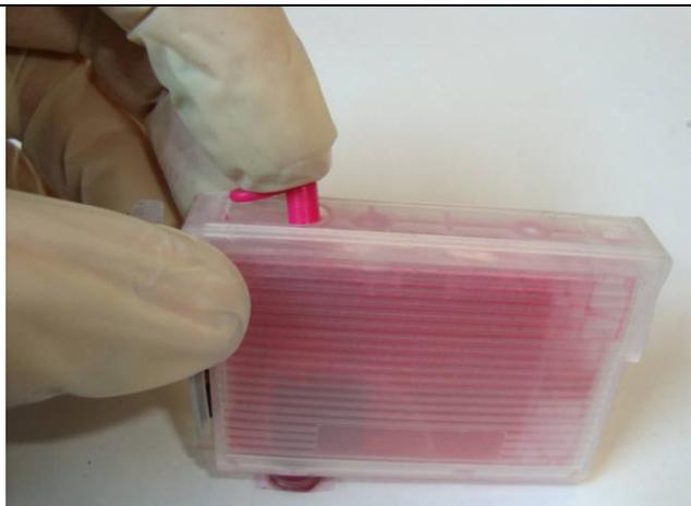
5. Вытащите шприц и вставьте пробку в отверстие вместо шприца.
