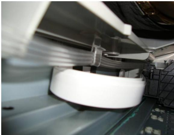
Устанавливаем клипсу для шлейфа в каретке, максимально вертикально. Просовываем через клипсу каретки чернильный шлейф, и одеваем капсулы на иглы ПГ соответственно цветам на крышке корпуса, оставляя петлю из шлейфа в каретке с запасом. При помощи линейки отмечаем на корпусе 15 см от левого внутреннего края корпуса, ставим метку. Обезжираиваем место крепления
