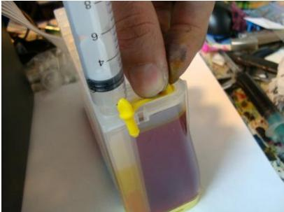
Опустошив меньшую, воздушную ёмкость, закройте пробкой чернильную ёмкость и вытащите шприц. Повторите для оставшихся цветов. Вставляем на место воздушной пробки воздушный фильтр, который будет очищать попадаемый внутрь ёмкости воздух.
