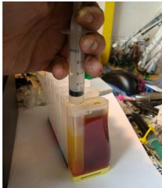
Вставляем открытый шприц в ёмкость с чернилами (воздушный фильтр предварительно снять), открываем пробку в капсуле соответствующего цвета, и очень медленно надавливая на шприц, наполнить капсулу чернилами ровно наполовину, можете предварительно пометить на капсулах маркером половину. При заполнении капсулы на 50% чернилами, сразу
