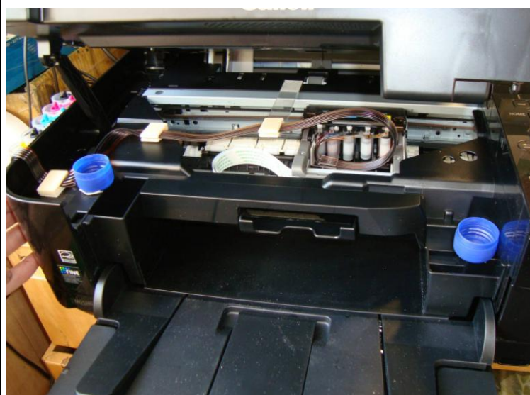
3.6. Закрепите на внутренней крышке, слева, зажимы для шлейфа.
