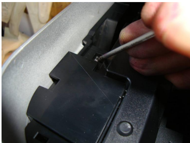
3.7. Нажмите отвёрткой на фиксирующий зажим боковой панели. Оттяните левую боковую крышку.
