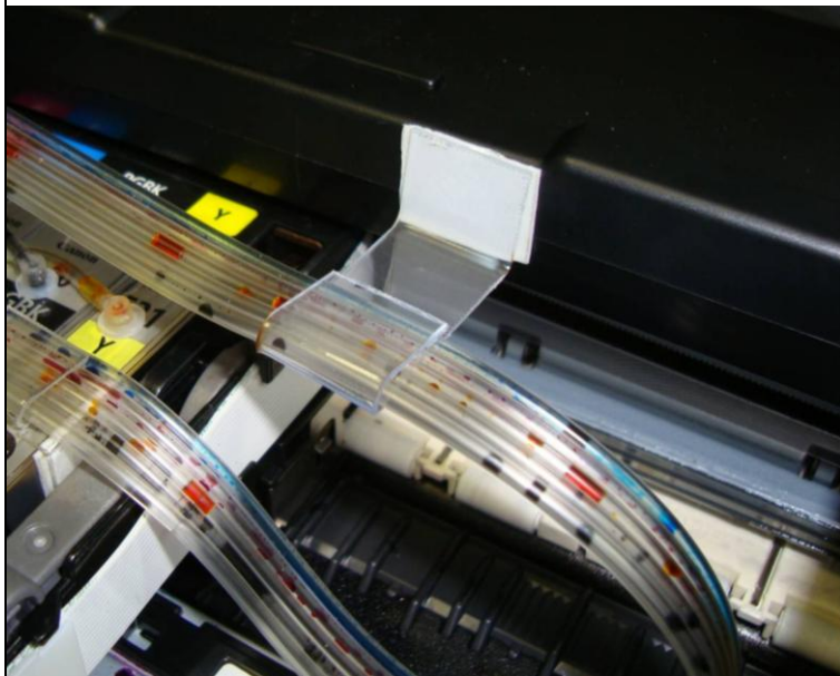
3.13. Для принтера установите упор, на корпусе, посередине, над кареткой, проверьте заранее, положение крепления.
