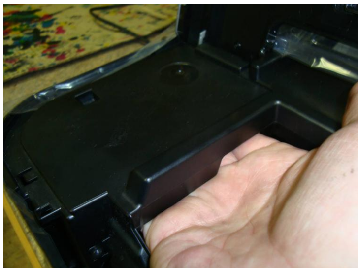
3.9. Для принтера выламываем внутренние перегородки, на верхней крышке. Слева и справа.
