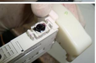
Возьмите программатор и приложите контактами к контактам картриджа. Светодиод замигает, удерживайте программатор до полного непрерывного горения зелёным.
