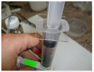
Вставляем шприц в манжету картриджа, начинаем вытаскивать поршень из шприца, Вы должны ощутить значительное сопротивление при вытаскивании поршня. Когда поршень выйдет из шприца до вырезов, вставьте в поршень запорную пластину.
