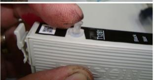
Переверните картридж трубкой вверх, подымите картридж ывше банки с чернилами, отсоедините трубку с уголком, установите трубку обратно в крышку банки.
