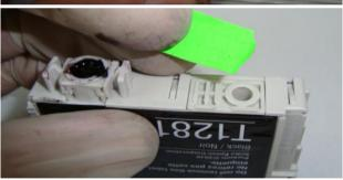
Снимите с клапана наклейку и укрепите её на ребристой поверхности картриджа, вы можете повторно её использовать несколько раз.
