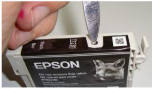
Острым ножом вырезаем большой вырез в наклейке, снимаем заусенцы с краёв отверстия.
