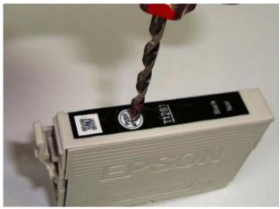
Берём сверло из набора и сверлим картридж в центре круга на наклейке. Сверло будет сверлить отверстие глубиной 3 мм, потом нагрузка уменьшится, и возможно появятся чернила, остановитесь, не продолжайте сверление. Вытащите сверло вместе со стружкой.
